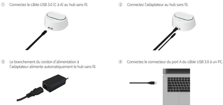
※ Le port USB est utilisé uniquement pour la transmission du signal.
