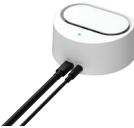
Quando l'i700 wireless è acceso, cercherà automaticamente di assocarsi all'hub wireless. Sia il manipolo i700 wireless che l'hub wireless devono essere alimentati e posizionati a distanza l'uno dall'altro per potersi associare. Quando l'associazione è in corso, il LED sulla parte superiore del manipolo dell'i700 wireless lampeggia. Una volta completata l'associazione, il LED rimane acceso. È possibile avviare la scansione al termine dell'associazione.
