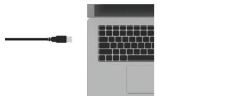
※ Der USB-Anschluss wird nur zur Signalübertragung benutzt.
