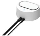
i700 wireless의 전원이 인가되면 자동으로 무선 허브와 페어링을 시도합니다. 페어링할 때 i700 wireless 본체와 무선 허브가 함께 전원이 인가되어야 하고 서로 가까이 위치해야 합니다. 페어링이 진행 중이면 i700 wireless 본체 상단의 LED가 점멸되고, 페어링이 완료되면 본체 상단의 LED가 점등됩니다. 페어링이 완료된 후 스캔을 수행할 수 있습니다.
