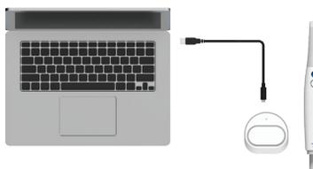
① Připojte napájecí kabel (C do C) k bezdrátovému rozbočovači.
