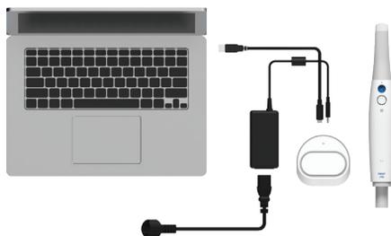
① Připojte kabel USB 3.0 (C na A) k bezdrátovému rozbočovači.
