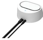
Când i700 wireless este pornit, va încerca automat să se asocieze cu hub-ul fără fir. Atât piesa de mână i700 wireless cât și hub-ul fără fir vor fi alimentate și plasate la o rază de cealaltă pentru a se asocia. Când asocierea este în progres, lumina LED din partea de sus a piesei de mână i700 wireless scilipește. Când asocierea este completă, LED-ul se aprinde. Poți începe scanarea atunci când asocierea este completă.
