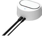
i700 wireless açıldığında, kablosuz hub ile otomatik olarak eşleşmeye çalışacaktır. Hem i700 wireless piyasemini hem de kablosuz hub'a güç verilmeli ve eşleşme için birbirinin aralığına yerleştirilmelidir. Eşleştirme devam ederken, i700 wireless piyaseminin üstündeki LED yanıp söner. Eşleştirme tamamlandığında LED yanar. Eşleştirme tamamlandığında taramaya başlayabilirsiniz.
