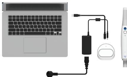
① Conectează cablul USB 3.0 (C la A) la hub-ul fără fir.
