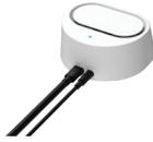
Bekapcsolása után az i700 wireless automatikusan megpróbál csatlakozni a vezeték nélküli hubhoz. Az i700 wireless kézi eszközt és a vezeték nélküli hubot egyaránt áram alá kell helyezni úgy, hogy megegyező sávszélességen működjenek. Az eszközök párosítása közben az i700 wireless kézi eszköz felső részén található LED kijelző villog. A párosítás befejeztével a LED kijelző világít. A szkennelést a párosítás befejeztével megkezdheti.
