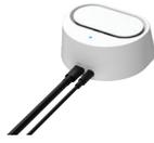
Коли i700 wireless увімкнено, вона автоматично намагається сполучитися з бездротовим вузлом. Ручна частина i700 wireless та бездротовий вузол мають бути під'єднані до живлення та розташовані в радіусі дії один одного для сполучення між ними. Коли сполучення між ними виконується, світлодіод зверху ручної частини i700 wireless блимає. Коли сполучення виконано, світлодіод світиться. Ви можете почати сканування, коли сполучення виконано.
