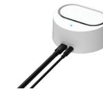
Når i700 wireless tændes, vil den automatisk forsøge at parre sig med den trådløse hub. Både i700 wireless's håndstykke og den trådløse hub skal tilsluttes strøm og placeres indenfor en vis rækkevidde for hinanden for at kunne parres. Når parringen er i gang, vil LED-indikatoren øverst på i700 wireless's håndstykke blinke. Når parringen er gennemført, vil LED-indikatoren lyse. Du kan påbegynde scanningen, så snart parringen er gennemført.
