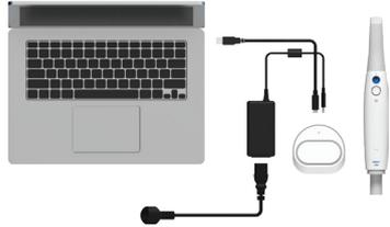
① Conecte o cabo USB 3.0 (Tipo C - Tipo A) ao hub wireless.
