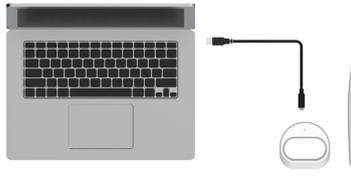
① Sluit de PD-kabel (C naar C) aan op de draadloze hub.
