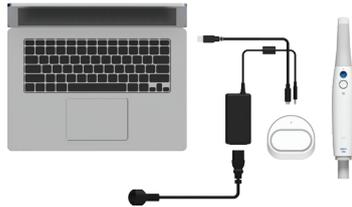
① Tilslut USB 3.0-kablet (C til A) til den trådløse hub.
