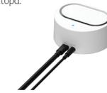
Όταν το i700 wireless είναι ενεργοποιημένο, θα προσπαθήσει να συνδεθεί αυτόματα με τον ασύρματο διανομέα. Τόσο η χειρολαβή του i700 wireless όσο και ο ασύρματος διανομέας θα πρέπει να τροφοδοτούνται και να τοποθετούνται σε κοντινή απόσταση μεταξύ τους για σύνδεση. Όταν η σύνδεση βρίσκεται σε εξέλιξη, η λυχνία LED στο πάνω μέρος της χειρολαβής του i700 wireless αναβοβρόηνει. Όταν ολοκληρωθεί η σύνδεση, η λυχνία LED ανάβει. Μπορείτε να ξεκινήσετε τη σάρωση όταν ολοκληρωθεί η σύνδεση.
