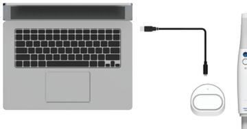
① Conecte el cable de alimentación (C a C) al concentrador inalámbrico.
