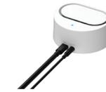
Når i700 wireless er slått på, vil den automatisk prøve å koble seg til den trådløse huben. Både i700 wireless-håndtaket og den trådløse huben må være tilkoblet og plassert i hverandres rekkevidde for å kunne pares. Når paring pågår, blinker LED-lyset på toppen av i700 wireless-håndtaket. Når paringen er fullført, vil LED lyse. Du kan begynne å skanne når paringen er fullført.
