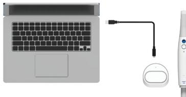
① Koble strømforsyningskabelen (C til C) til den trådløse huben.
