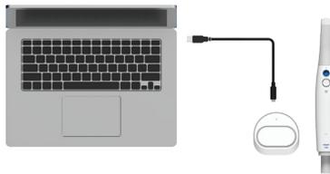
① Conecte o cabo de alimentação (C - C) ao hub wireless.
