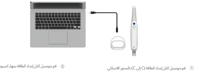
① قم بتوصيل كابل إمداد الطاقة (C إلى C) بالمحور الاسلكي.
